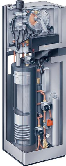
Das Funktionsprinzip des Heizsystems basiert auf der Verwendung von Zeolith (Siedestein). Zeolith nimmt Wasserdampf auf, der im Wärmepumpenmodul aus Erdwärme oder Solarthermie erzeugt wurde. Durch die Dampfaufnahme (Adsorption) entstehen hohe Temperaturen, die zum Heizen genutzt werden.
